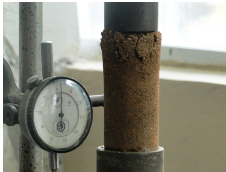
FIGURA 80 - ROMPIMENTO DO CORPO DE PROVA
