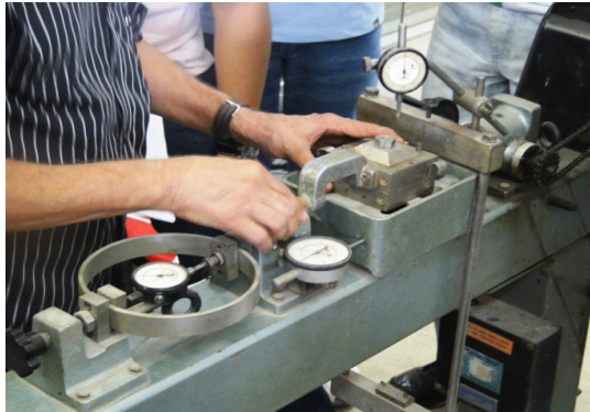
FIGURA 64 - INSTALAÇÃO DA CAIXA DE CISALHAMENTO NA PRENSA
