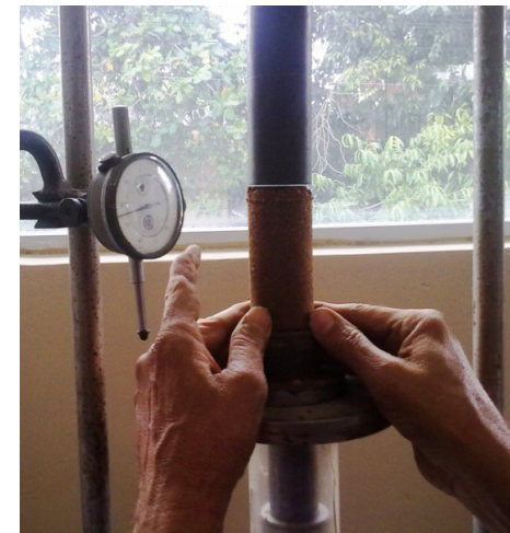
FIGURA 75 - CORPO DE PROVA NO PEDESTAL SEM CONFINAMENTO
