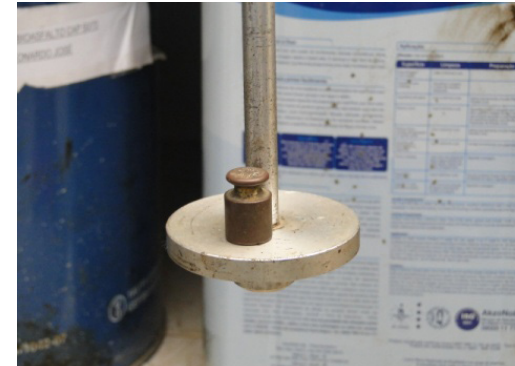
FIGURA 54 - CARGA POSTA PARA APLICAÇÃO DO PRÉ-ADENSAMENTO
