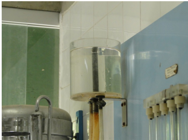
FIGURA 41 - RESERVATÓRIO COM EXTRAVASOR CENTRAL (TUBO PRETO)
