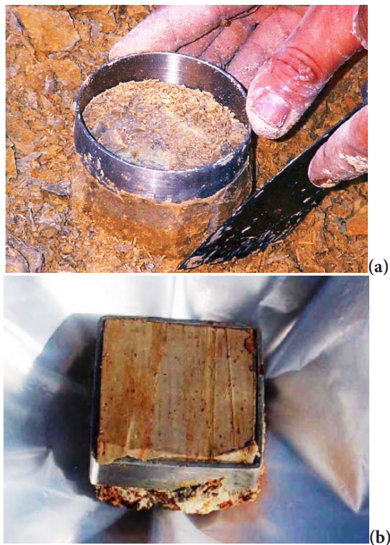
FIGURA 02 - RETIRADA DE AMOSTRA INDEFORMADA UTILIZANDO ANÉIS METÁLICOS: (A) CILÍNDRICO; (B) RETANGULAR
