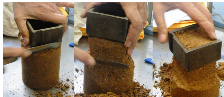
FIGURA 62 - SEQUÊNCIA DE TALHAGEM DO CORPO DE PROVA PARA ENCAIXE NO MOLDE RETANGULAR
