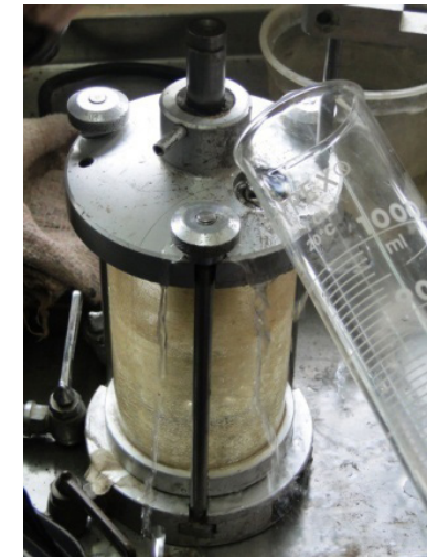
FIGURA 73 - COLOCAÇÃO DA ÁGUA, COM FUNÇÃO DE APLICAR A TENSÃO CONFINANTE
