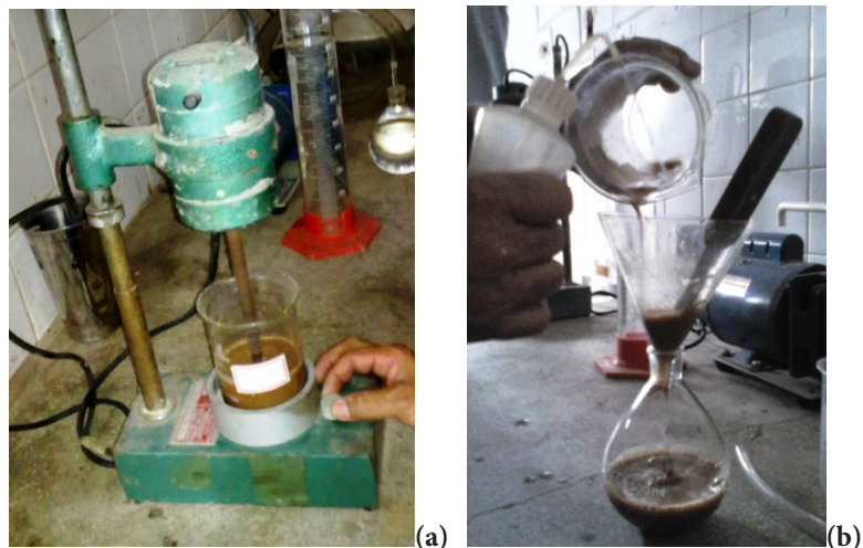
FIGURA 12 - (A) DISPERSOR DE MOLÉCULAS; (B) APÓS O DISPERSOR, AMOSTRA SENDO PASSADA PARA O PICNÔMETRO
