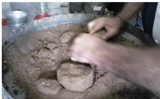
FIGURA 31 - DESTORROAMENTO DO MATERIAL E JUNÇÃO COM O MATERIAL DA BANDEJA
