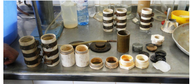
FIGURA 77 - ALGUNS DOS MATERIAIS USADOS NA COMPACTAÇÃO
