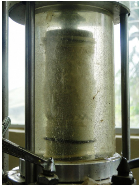
FIGURA 74 - RUPTURA DO CORPO DE PROVA
