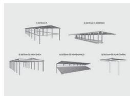
PÁG. 537 | Figura 221\_ Esquemas das tipologias de estruturas produzidas pela Premol para o segmento da construção civil. Fonte: Ivanilson Pereira, 2019.
