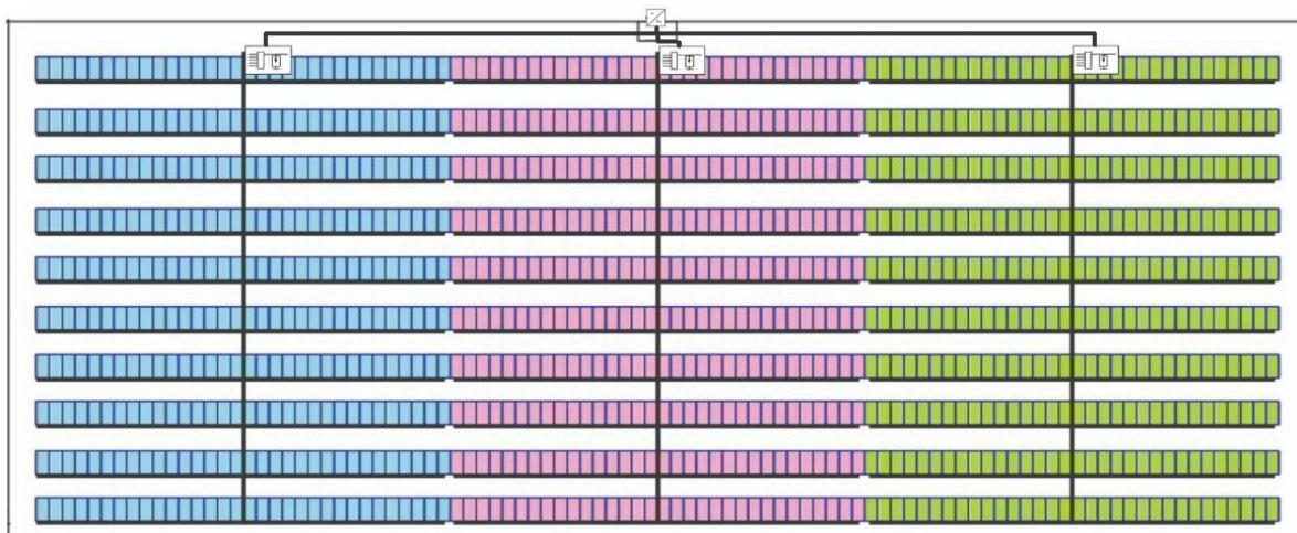
Figura 9: Esquema de ligação para caixas de junção distribuídas
