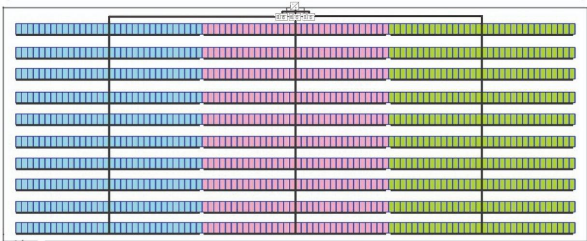
Figura 7: Esquema de ligação para caixas de junção centralizadas
