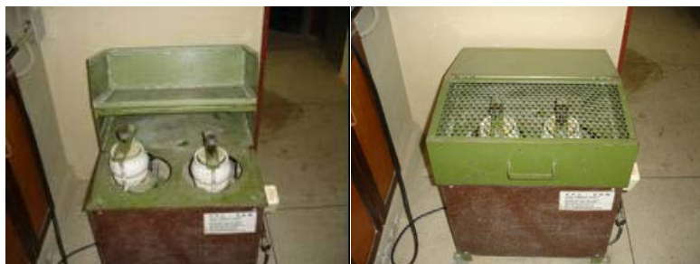
FIGURA 2 – MOINHO DE BOLAS (A) POSICIONAMENTO DOS RECIPIENTES (B) EM FUNCIONAMENTO
