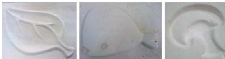
FIGURA 14 – MOLDES EM CONCRETO CELULAR DESENVOLVIDOS PELO GRUPO
