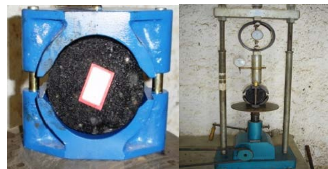
FIGURA 4 - EQUIPAMENTOS UTILIZADOS PARA REALIZAÇÃO DO ENSAIO MARSHALL (A) MOLDE (B) PRENSA + MOLDE
