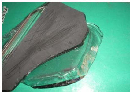
FIGURA 1 – VIDRO DA TELA E DO FUNIL DO MONITOR
