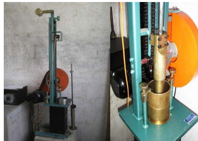
FIGURA 3 - EQUIPAMENTOS UTILIZADOS PARA REALIZAÇÃO DA COMPACTAÇÃO DOS CORPOS DE PROVA (A) COMPACTADOR (B) SOQUETE + CILINDRO
