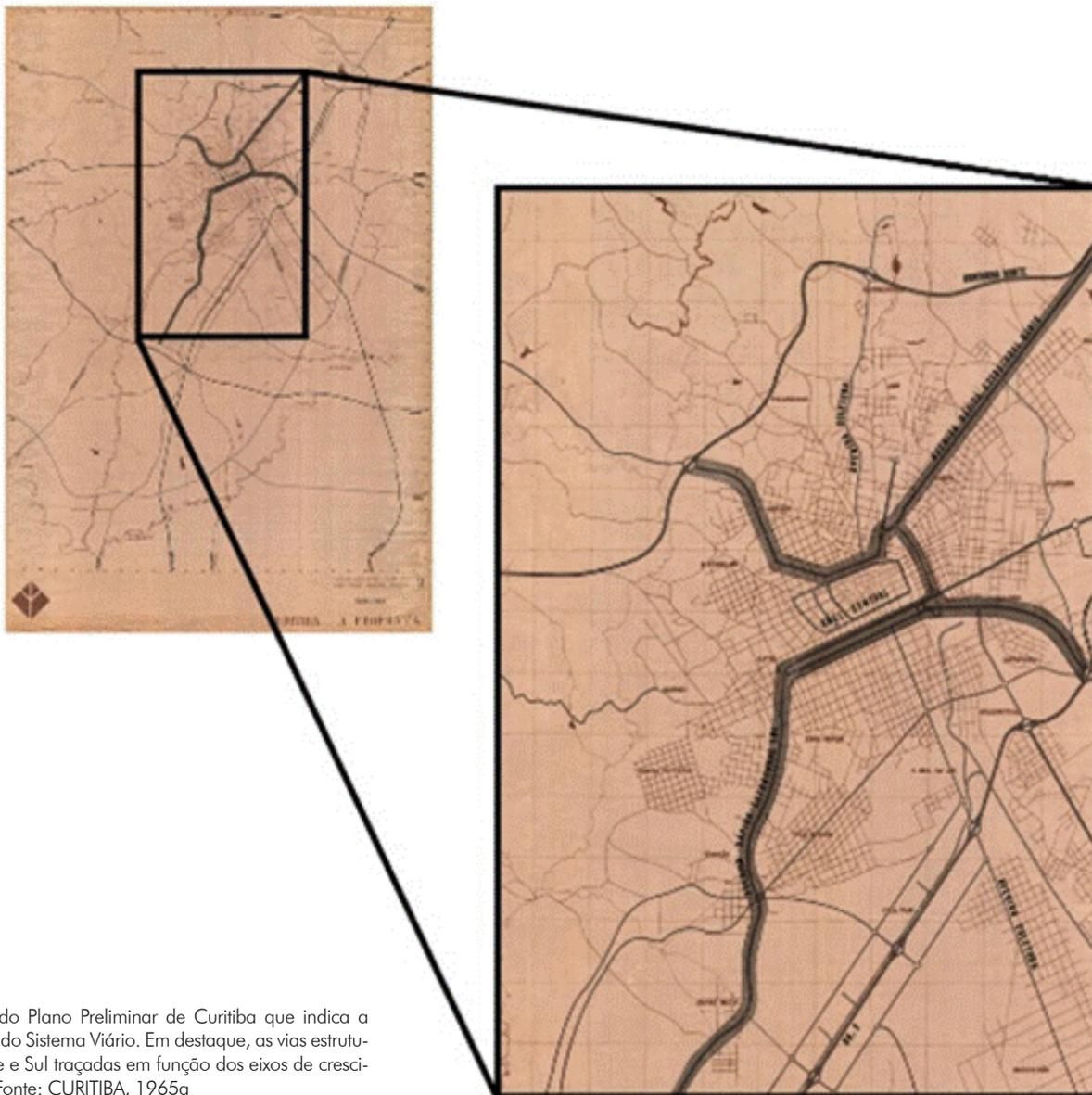
Prancha do Plano Preliminar de Curitiba que indica a proposta do Sistema Viário. Em destaque, as vias estruturais Norte e Sul traçadas em função dos eixos de crescimentos. Fonte: CURITIBA, 1965a
