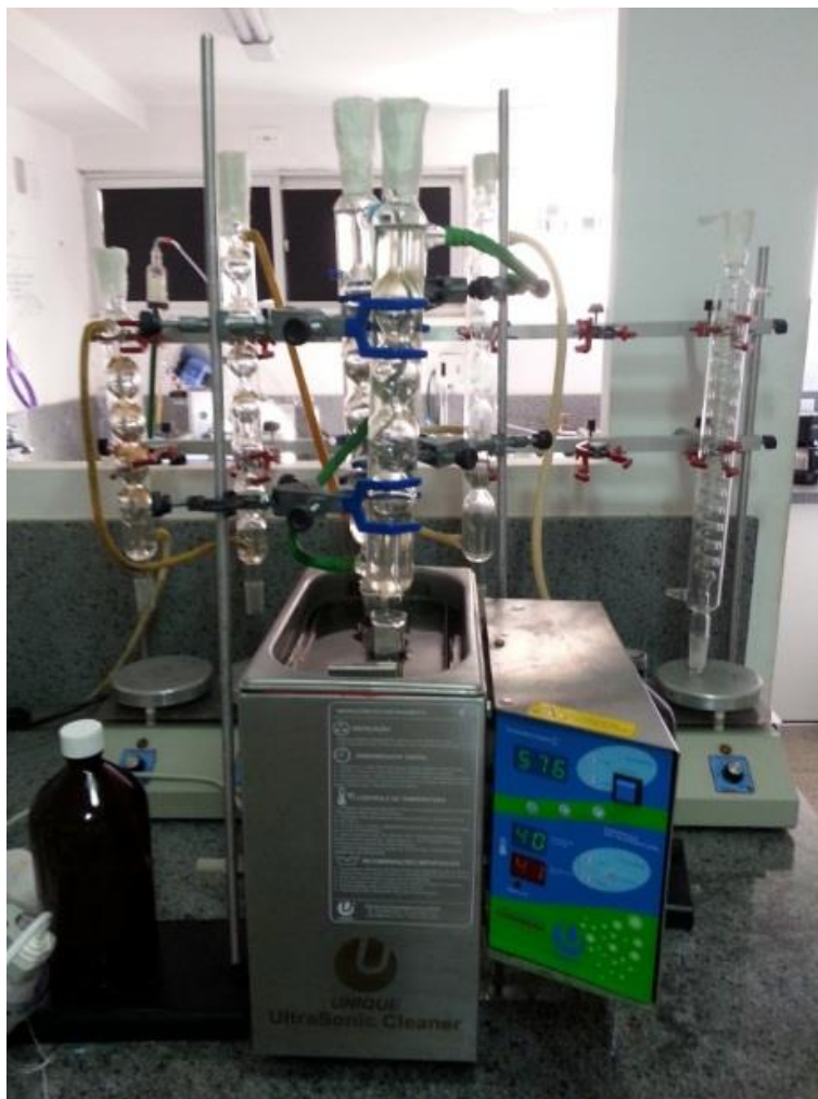
Figura 1- Sistema de refluxo conjugado a um balão de duas vias e acoplado a um sistema de aquecimento e tempo controlado, utilizando banho de ultrassom
